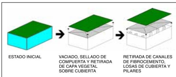
Figura 2. Esquema de la etapas para el vaciado del vaso del depósito.
